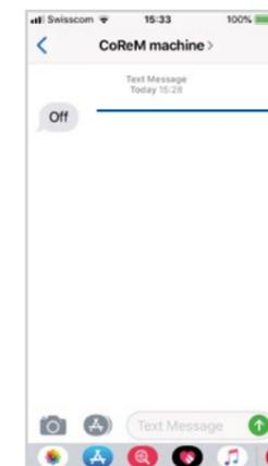
SMS zu Maschine wird ohne Header gesendet, damit es kompatibel mit den meisten Maschinen ist, z.B. Alarm Server, usw.
