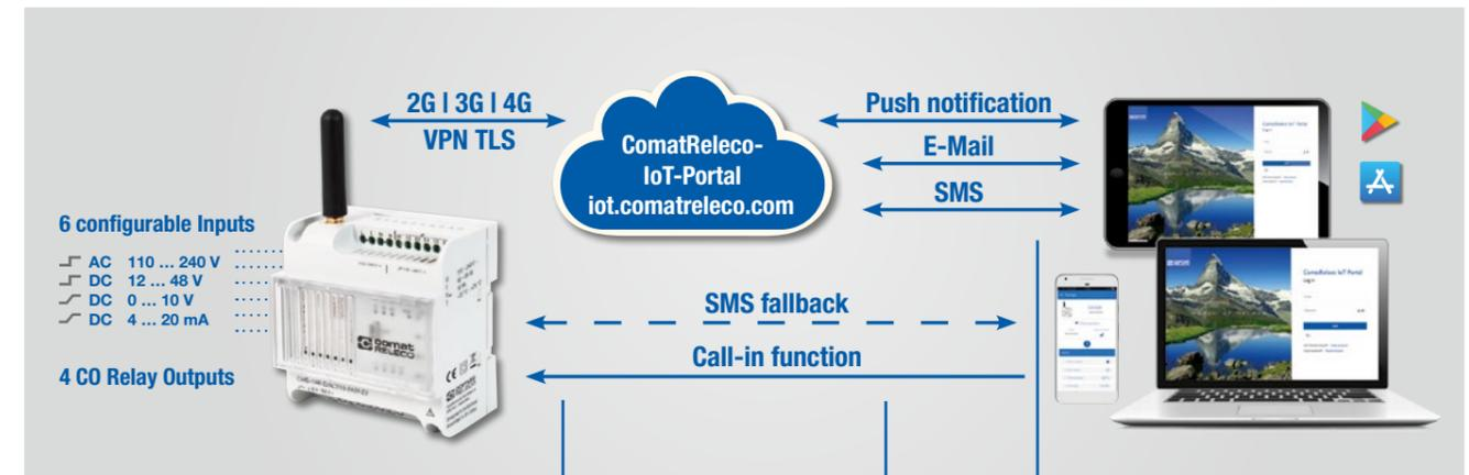
Das CMS-10R Gerät empfängt SMS Benachrichtigungen mit der Telefonnummer der integrierten eSIM. Die gleiche Nummer gilt für Call-in und SMS fallback.
