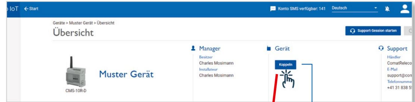
Gerät koppeln, d.h. das Gerät mit dem IoT Portal verbinden und die Konfiguration übernehmen. Sicherstellen, dass das Gerät unter Spannung ist. Dann auf dem Gerät «Pair» drücken. Mit dem Koppeln startet das «Dienstleistungsprofil» und somit die Verrechnung.
