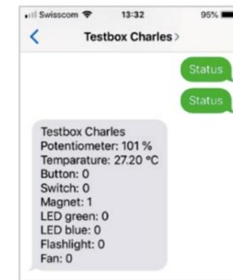
Im Fallback Modus kann eine SMS Nachricht «Status» zum Gerät gesendet werden und der Status von allen Ein-/Ausgängen wird zurückgesendet.
